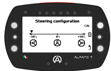
— Lenkrad-Kalibrierung an 3 Punkten
